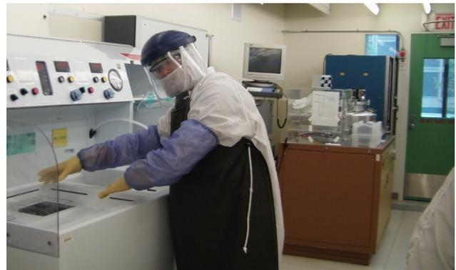
*Limpiando obleas de silicio en una mezcla de ácidos, durante un entrenamiento en procesos de fabricación de chips en el MIT Microsystems Technology Laboratories, (2011).*
